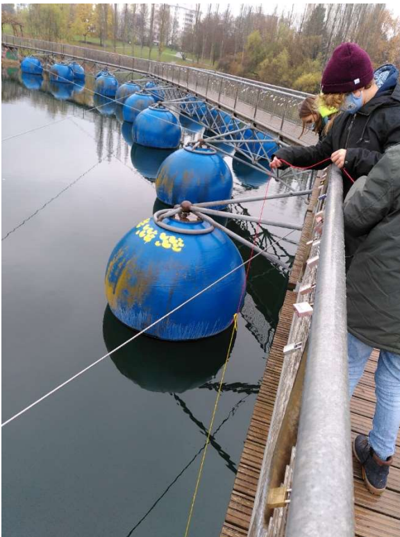
2 Sichttiefe messen mit der Secchi-Scheibe
